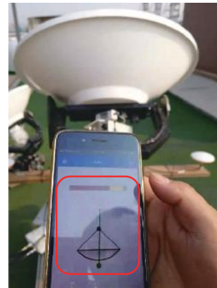
Step 4. 确认天线自动对准方向和寻星软件指向方向是否一致。
