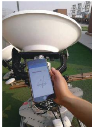
Step 3. 360°移动手机, 寻找信号最强点
