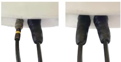
连接好后请用防水胶泥密封接头
